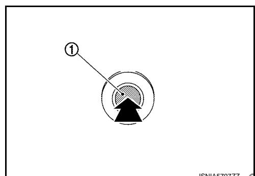
3. 沿图示箭头方向按压声纳传感器 ① 并从保险杠上拆下声纳传感器。
