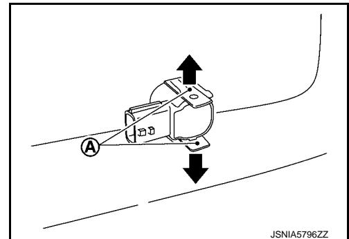
3. 沿图示箭头方向按压声纳传感器 ① 并从保险杠上拆下声纳传感器。
